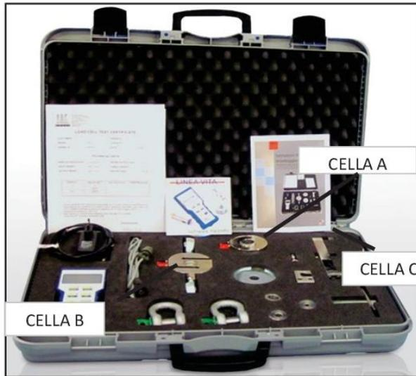
A) eseguire la prova di trazione a 5 kN come da capitolo 9.2.1 della norma UNI 11560:2014 (CELLA A)
