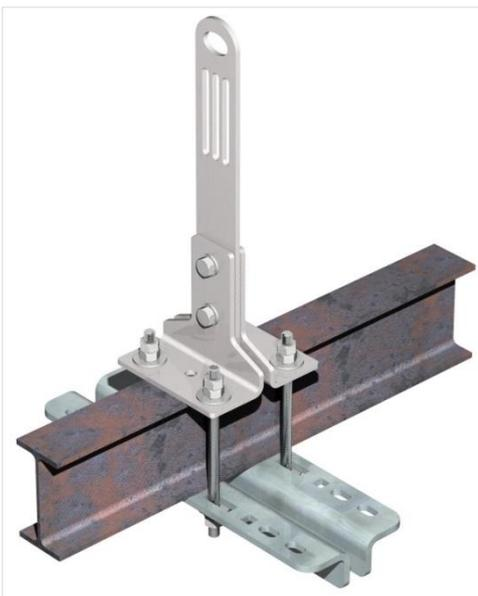
Collegare l'ancoraggio strutturale (palo) al kit semplice per incravattare mediante le 4 barre filettate M12 x 350 con rondella e dadi presenti nella confezione andando così a incravattare la struttura di supporto.
