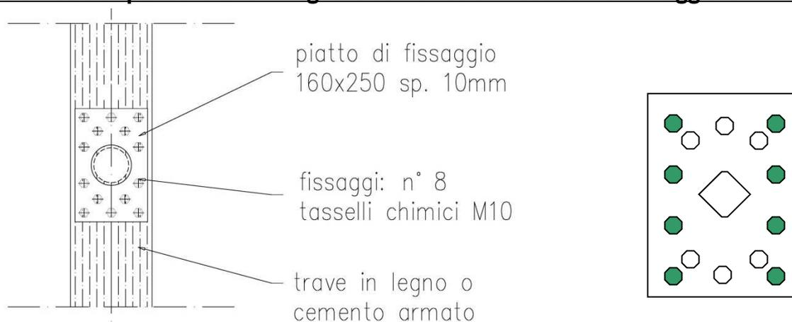
Installare n° 8 tasselli chimici M10 utilizzando i fori laterali come da schema riportato in alto. Mettere in opera, in ciascuno **dei 8 fori realizzati**, il tipo di resina (poliestere, vinilestere, epossidiche) adatta al tipo di applicazione + barra filettata+rondella +dado **seguendo le indicazioni del fornitore dei fissaggi.**
