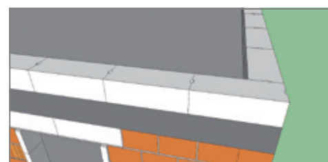
Nodo costruttivo: parapetto della terrazza
