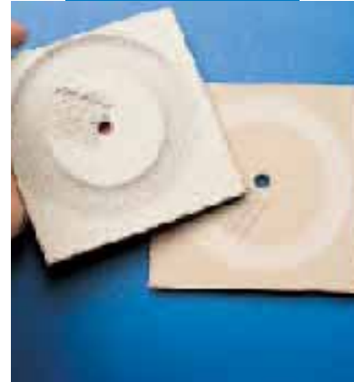
Abrasion Taber eseguita su Ultraplan (provino di destra) e rasatura convenzionale (provino di sinistra) dopo 200 giri
