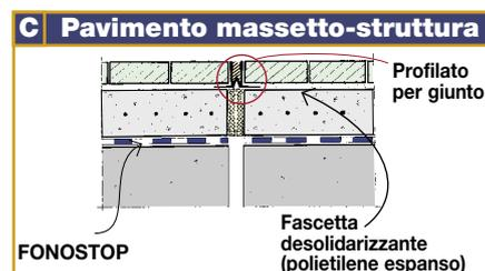
Fasi per la realizzazione di un giunto pavimento-massetto in corrispondenza della soglia di una porta.
