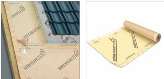
Wallint® T3 SK<sup>2</sup> ha due nastri acrilici adesivi laterali. L'incollaggio dei due nastri crea una giunzione sicura contro il passaggio dell'aria e del vento riducendo le dispersioni termiche.
