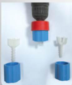
Svitatore: attaccato al trapano permette di svitare i livellatori dai tiranti (in senso antiorario).
